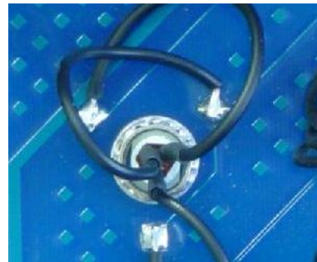
Après modification (la température maximale correspond bien à l'indication « max » de la sérigraphie).
